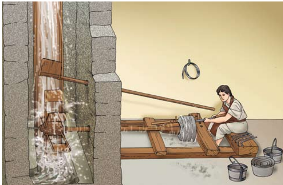
Ricostruzione di un tornio ad albero orizzontale mosso dalla forza idraulica (dis. M. Fuggiaschi).
